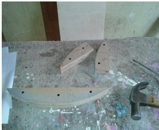
Foto 22. Elaboración de la base del balancín
