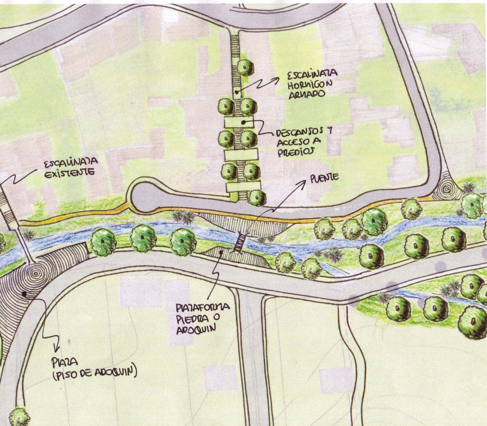
Fig. 6.61 Planta ubicación de escalinatas
