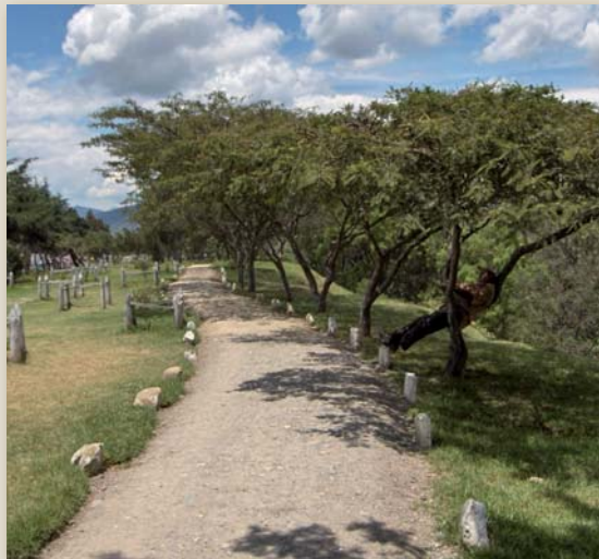
Fotografía N° 2.38 y N° 2.39 , Parque La Tebaida, caminera de lastre con bordes de piedra de río y de mina,
