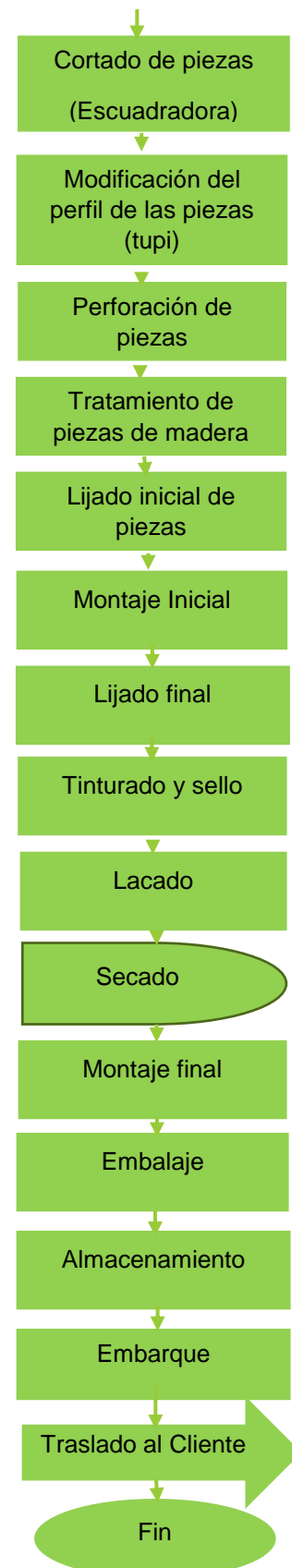
Gráfico N° 72: Diagrama de flujo del proceso de muebles de madera. Fuente: Departamento de producción.
