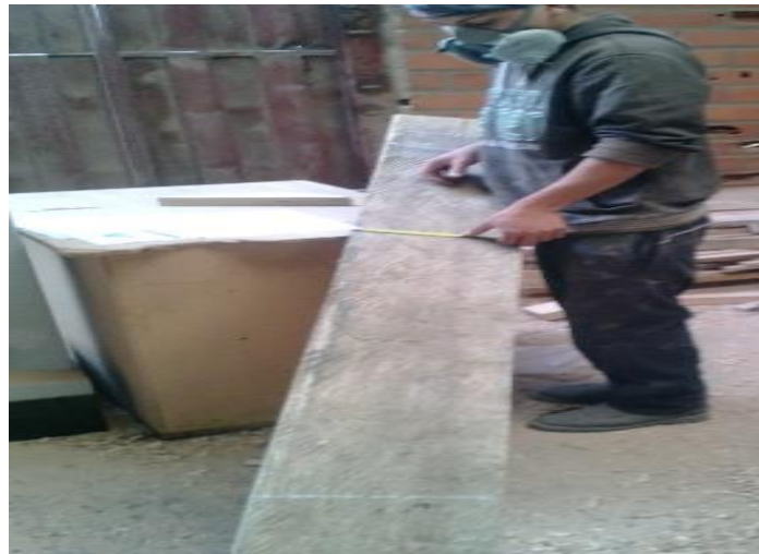
Gráfico N° 93: Preparación de tablones de madera Fuente: Las autoras
