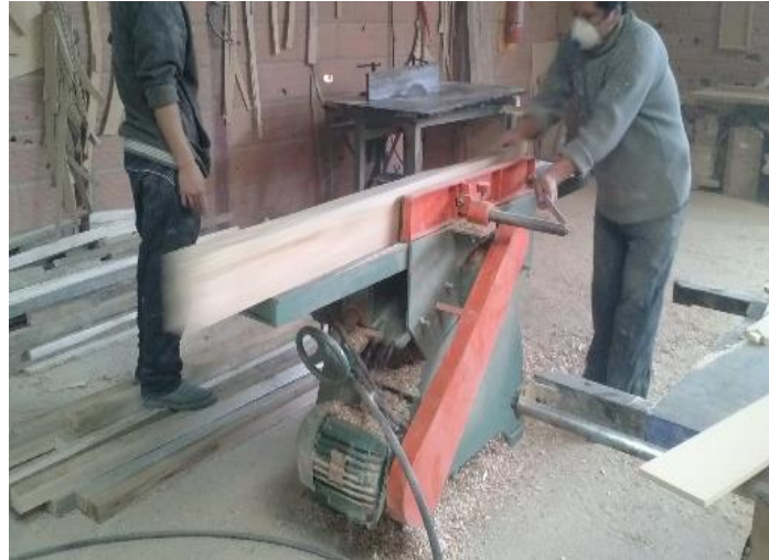
Gráfico N° 96: Planeado y canteado de tiras de madera Fuente: Las autoras
