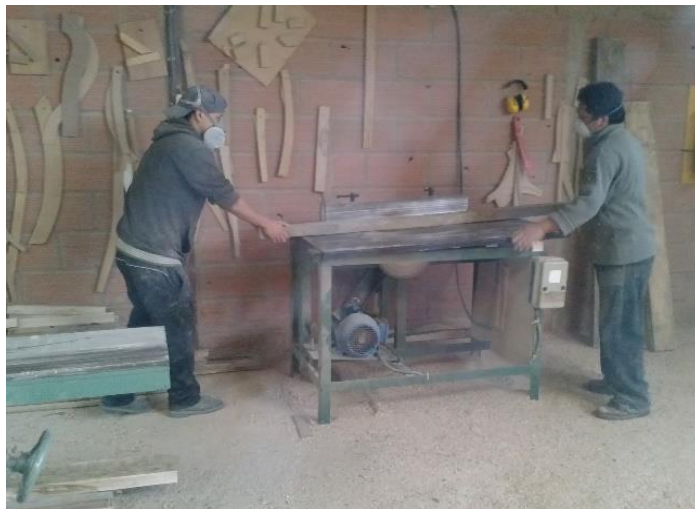
Gráfico N° 80: Obtención de tiras de madera Fuente: Las autoras
