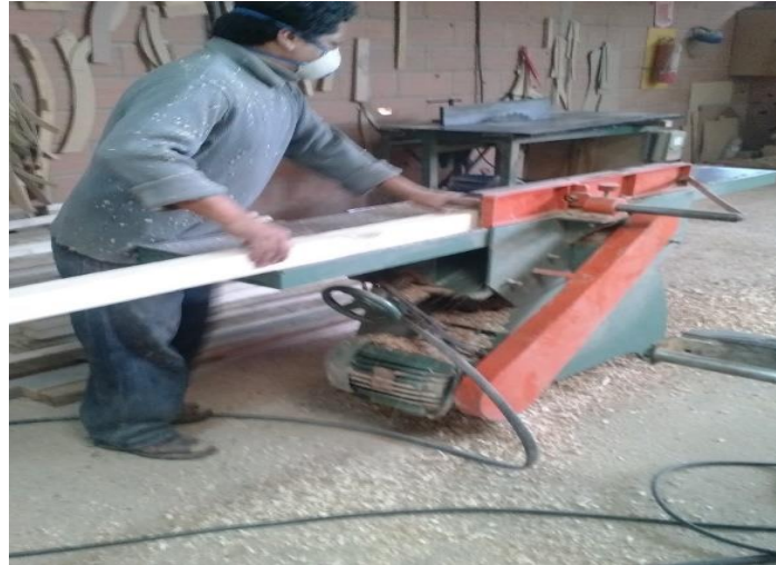
Gráfico N° 81: Planeado y canteado de la madera
