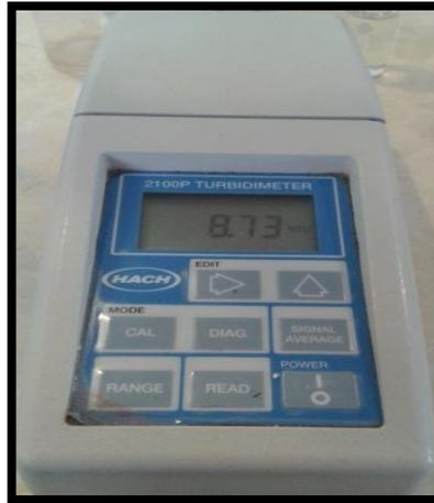
*Figura 1. Turbidímetro, marca HACH, modelo 2100 P.*
