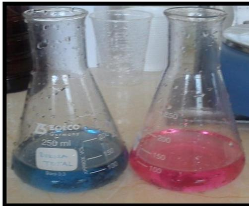
*Figura 5. Método titulométrico con EDTA: Dureza total*
