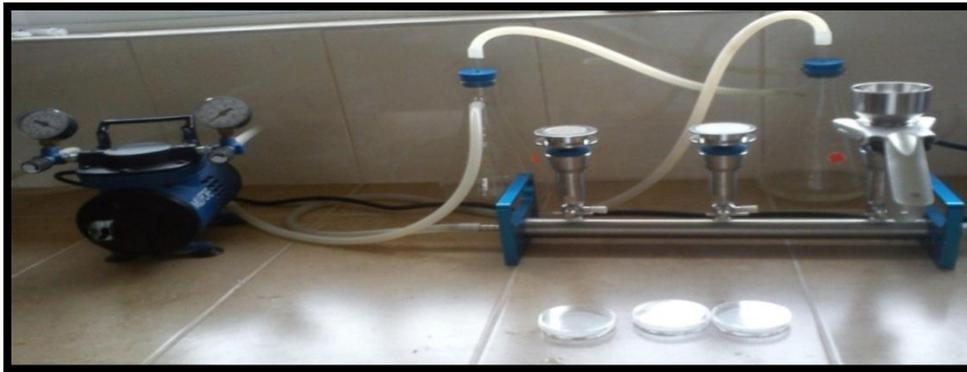
*Figura 13. Equipo para filtración de membrana*
