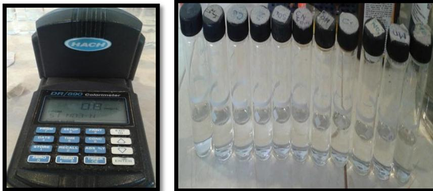
*Figura 9. Determinación de Nitratos.*
