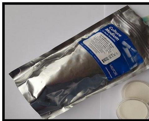
*Figura 14. Caldo m-ColiBlue24®, cajas Petri en poliestireno y membranas de esteres de celulosa de 0,45 micras de poro de Millipore.*
