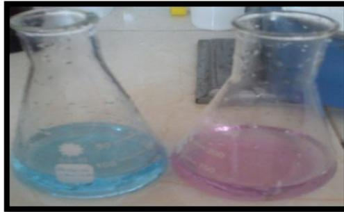
*Figura 6. Método titulométrico con EDTA: Dureza cálcica.*
