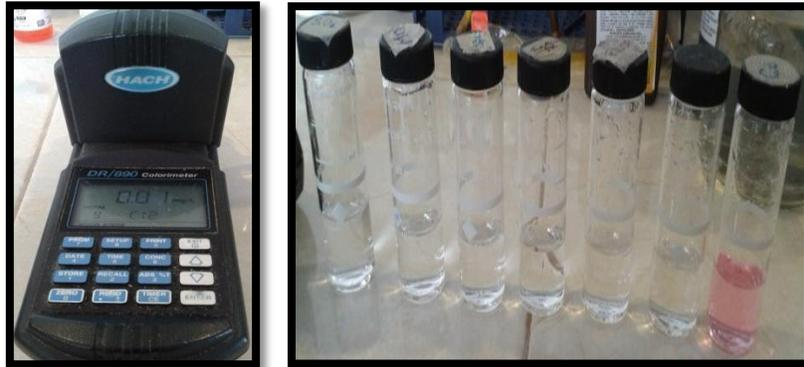
*Figura 12. Determinación de Cloro libre residual.*
