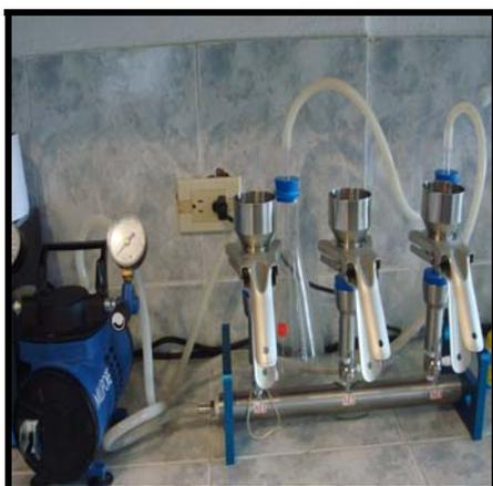
**Ilustración 20.** Equipo de Filtración por Membrana
