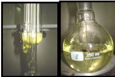
Figura 2.13. Extracción de grasa con éter
