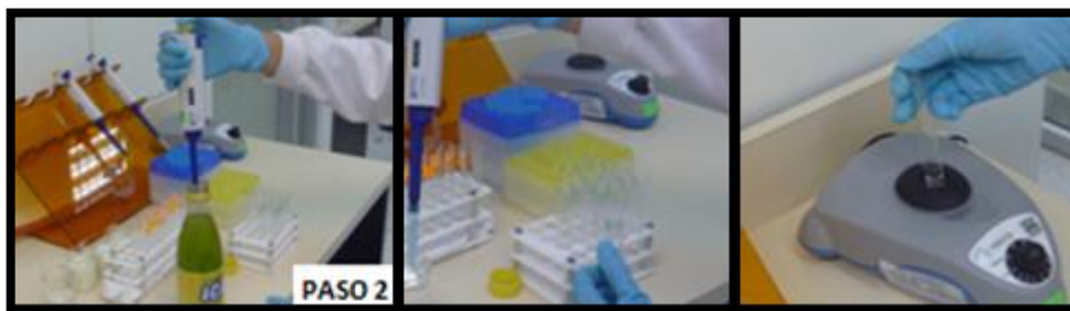
IMAGEN 2.2. PASO 2. Tomar 50 \mu\text{L} de la muestra y diluir en 950 \mu\text{L} de agua destilada y homogenizar en el vortex
