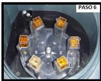
IMAGEN 2.18. PASO 6. Una vez cumplido el tiempo transferir las soluciones a las cubetas y colocar en las celdas colorimétricas
