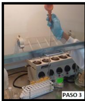
IMAGEN 2.15. PASO 3. Adicionar en forma rápida 2.5 mL de ácido sulfúrico concentrado sin deslizar el ácido por las paredes del tubo de ensayo
