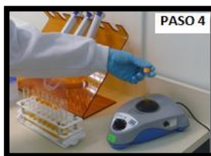
IMAGEN 2.16. PASO 4. Llevar al vortex para mezclar y capturar algunos restos de ácido por las paredes del tubo
