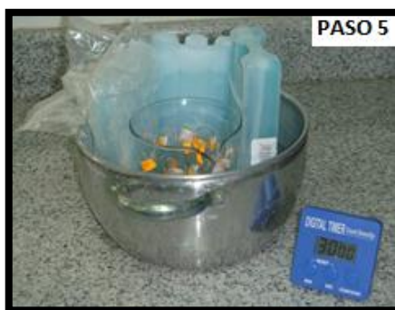
IMAGEN 2.17. PASO 5. Colocar todos los tubos en una olla con hielo y agua (Baño de hielo) por 30 minutos
