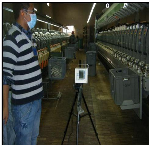
**Fig. 2.6 Medición de material particulado**
