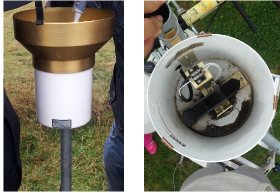
Figura 2.2.1. Exterior e interior del pluviómetro marca Texas Electronics modelo TE525MM.
