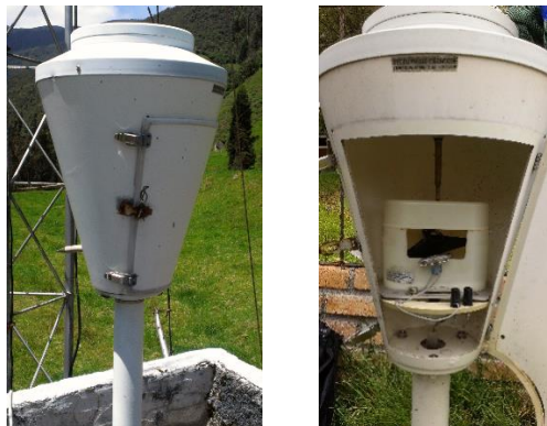
Figura 2.2.2. Exterior e interior del pluviómetro marca Précis Mécanique modelo 3032.
