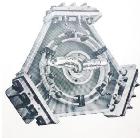
Figura 4.13: Ilustración del sistema de diodos rotativos instalados en los grupos e generación 1 y 2 [12]
