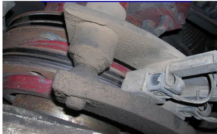
Figura 4.25: Polvo de carbón provocado por el desgaste de las escobillas [24].
