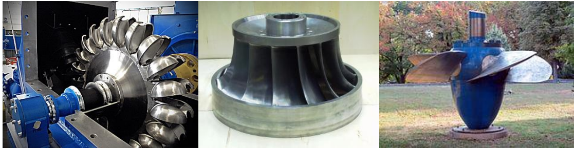
Figura 2.2: Tipos de turbinas de izquierda a derecha: Pelton, Francis, Kaplan.
