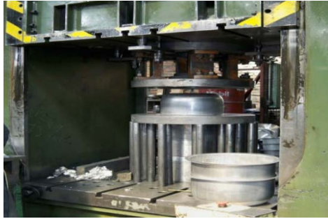
Foto N° 6: Embutido de disco
