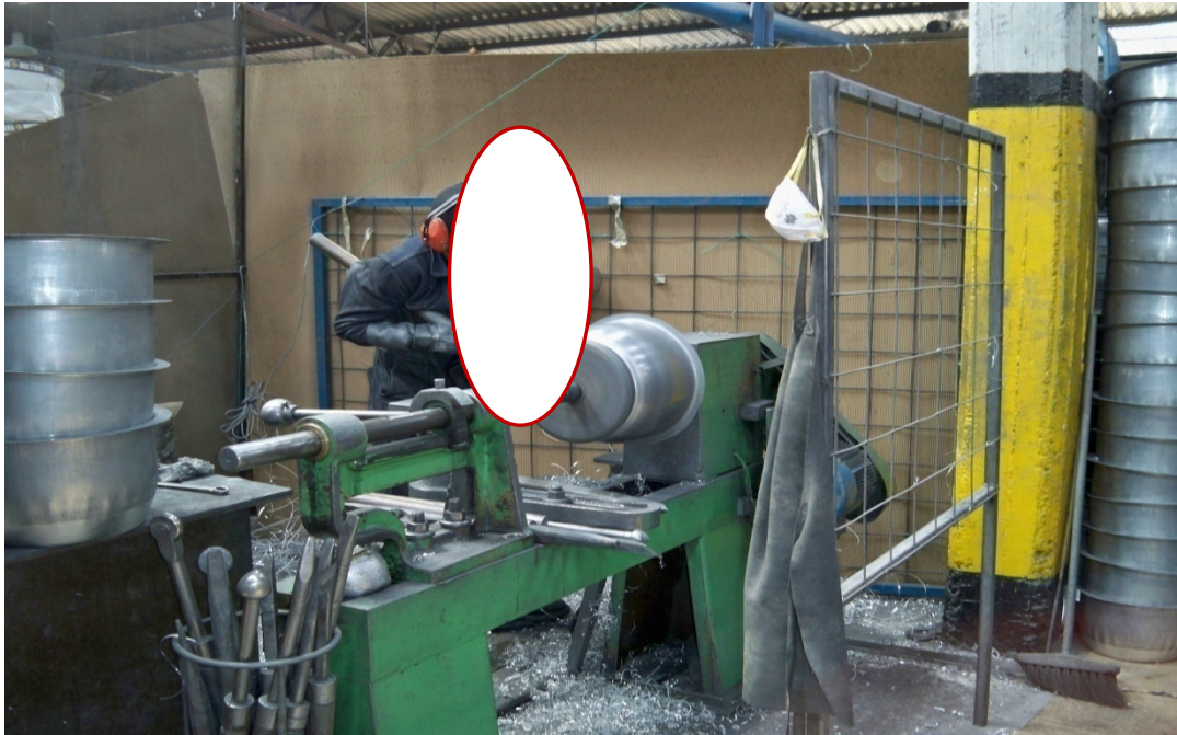
Foto 4: Falta de gafas de protección.
