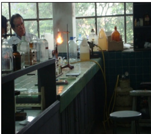
Fig.20c.- Cilindro de GLP sin protección junto a un mechero encendido, en el Laboratorio de Análisis Orgánico.
