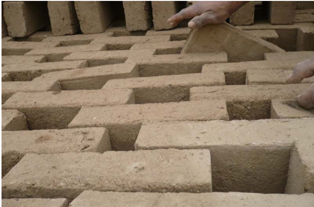
Fotografía 6: Disposición de ladrillos en el horno (Ladrillera de Susudel)
