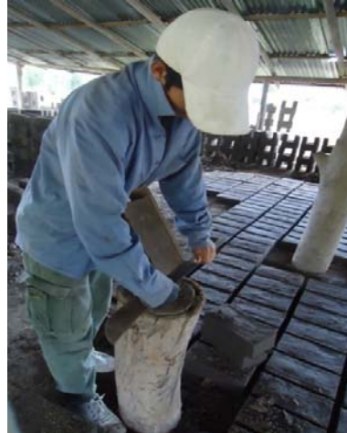
Fotografía 4: Raspado (Ladrillera de Susudel)
