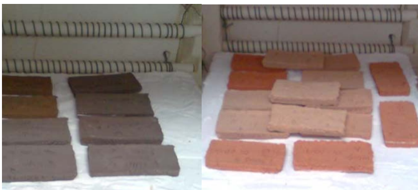
Fotografía 17: Ciclo de quema de las placas en el horno a 842°C
