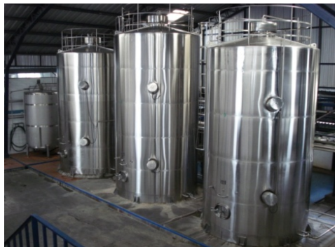
Silos de recepción de producto terminado
