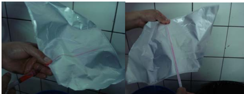
Pruebas de sellado de envases Tetrapack: Rojamina en línea - Tira adherida al papel
