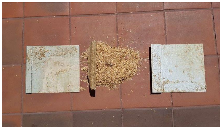
Ilustración 164: Láminas de acero separadas del núcleo Fuente: Propia
