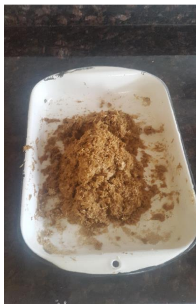
Ilustración 156: Mezcla de aglutinante con cascarilla molida Fuente: Propia
