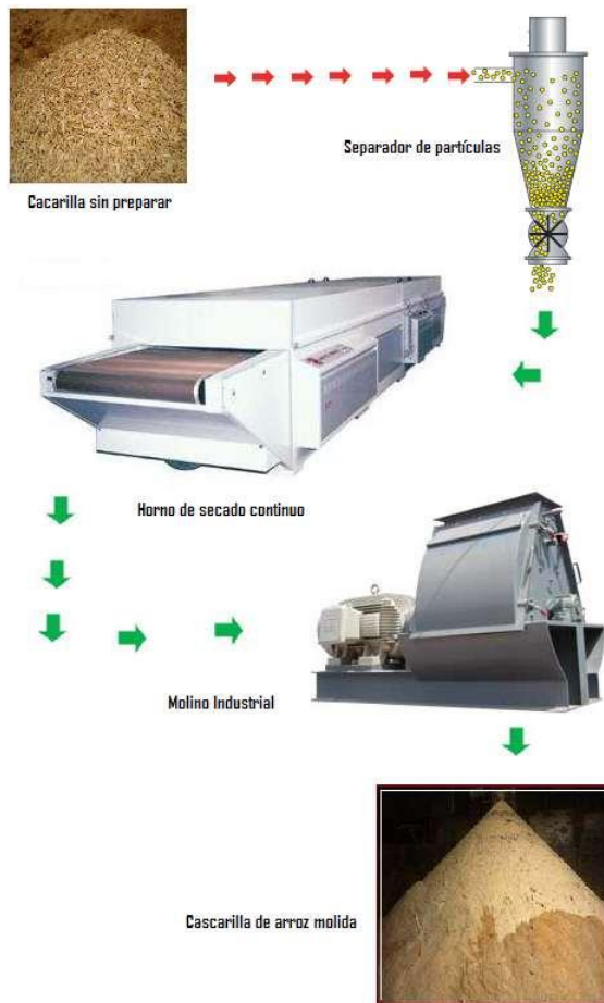
Ilustración 169: Proceso de preparación de cascarilla Fuente: Calero y Vásquez, 2012.
