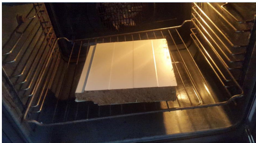
Ilustración 160: Panel secado en horno Fuente: Propia
