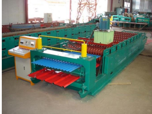
Ilustración 171: Máquina de rodillos para paneles metálicos Fuente: www.spanish.alibaba.com
