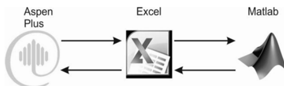
Figura 3. Esquema de información entre Aspen Plus® y Matlab® [19].
