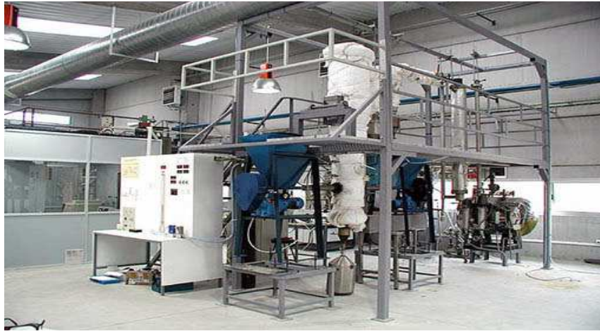
Figura 1. Planta piloto de 10 kW con sistema de lecho fluido burbujeante para combustión de residuos sólidos de carbón mineral.
