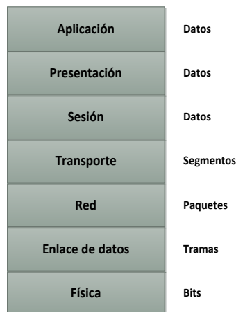
Figura 5.1. Capas del modelo OSI
