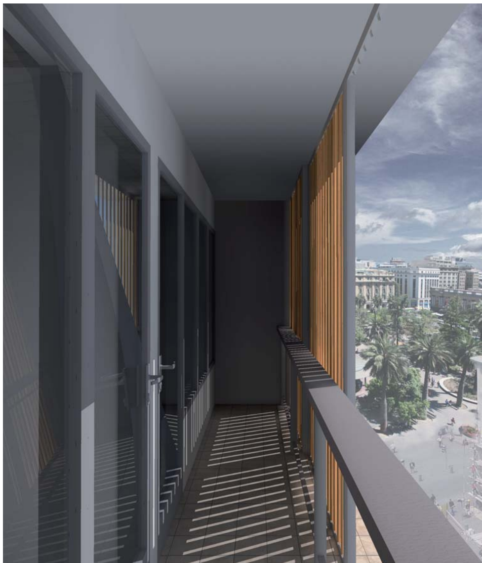
Imagen 145. Redibujo tridimensional del muro cortina, que comprende la fachada de vidrio, el balcón y el quebrasol con lamas de madera.
