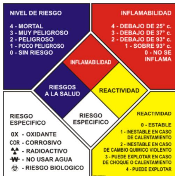
Ilustración 1: Rombo de comunicación de peligros NFPA 740
