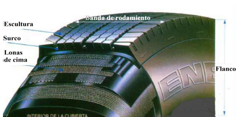
Ilustración 14: Partes externas de un neumático Fuente: (Ramos, Troitiño, & Del Amo García, 2002)
