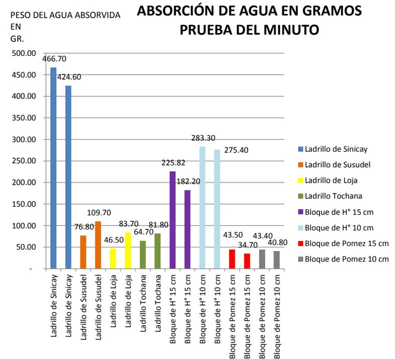
**ILUSTRACIÓN N° 34.** Absorción de agua en diferentes mampuestos utilizados en la ciudad de Cuenca.
