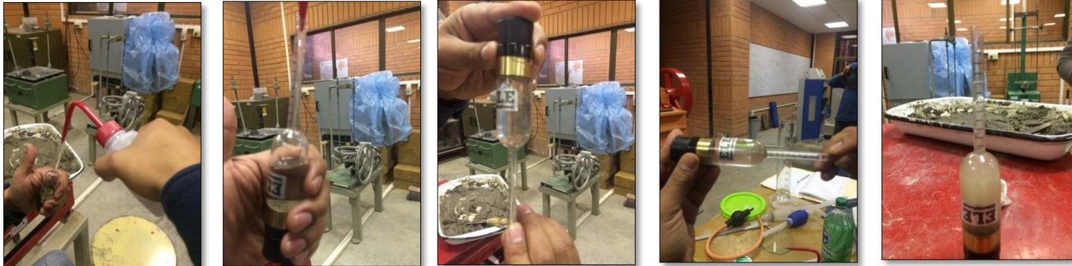
**ILUSTRACIÓN N° 14** Ensayo para determinar el contenido de aire en morteros
