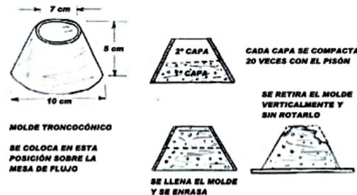
**ILUSTRACIÓN N° 2** Ensayo de fluidez, tomada de GUÍA PRÁCTICA. Morteros de pega para muros de mampostería
