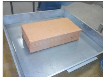
**ILUSTRACIÓN N° 17** mampuestos usados en nuestro medio, prueba de velocidad de absorción inicial.
