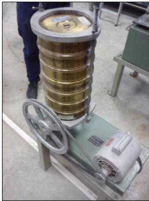
**ILUSTRACIÓN N° 9** Proceso de obtención de la granulometría del árido
