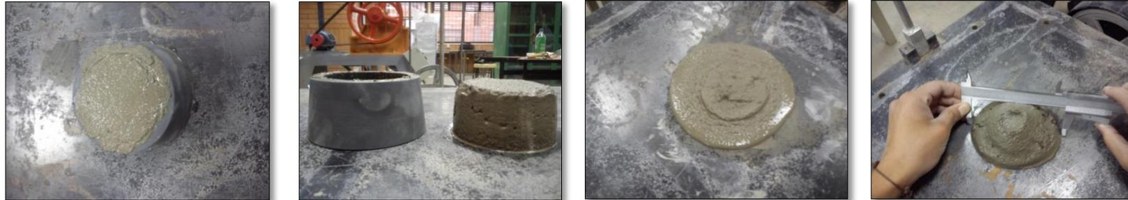
**ILUSTRACIÓN N° 13** Ensayo para determinar la fluidez de la pasta de mortero
