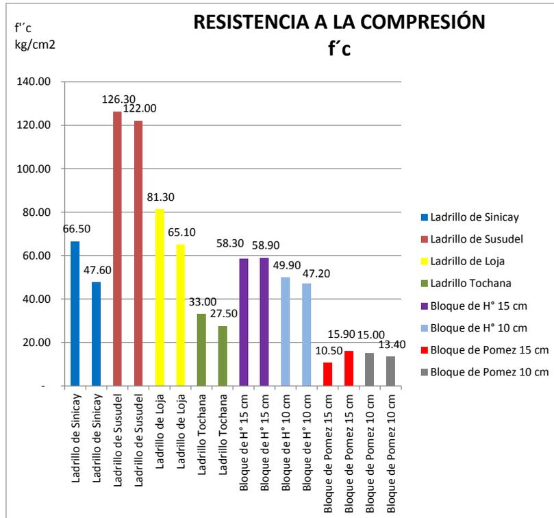
**ILUSTRACIÓN N° 35** Análisis de la resistencia a compresión  $f'c$ , de mampuestos utilizados en el cantón Cuenca
