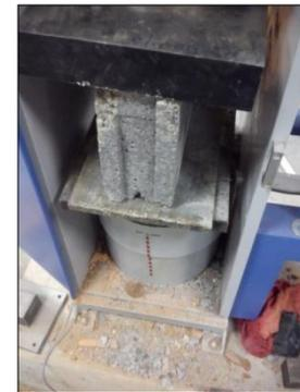
**ILUSTRACIÓN N° 18** Ensayo de resistencia a compresión del mampuesto
