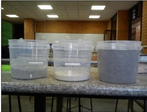
**ILUSTRACIÓN N° 12** dosificación volumétrica de morteros.
