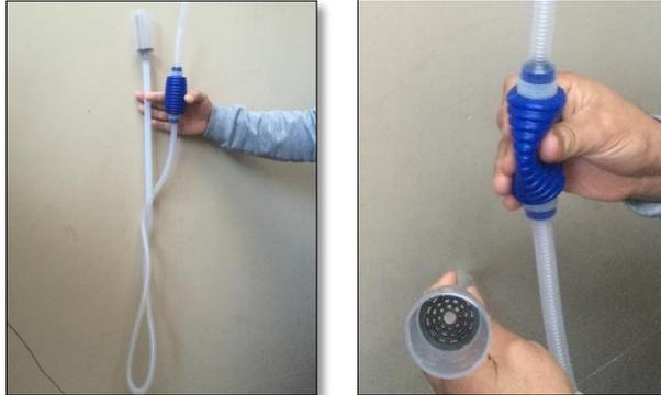
**ILUSTRACIÓN N° 15** copa con tronera y bomba manual de succión
