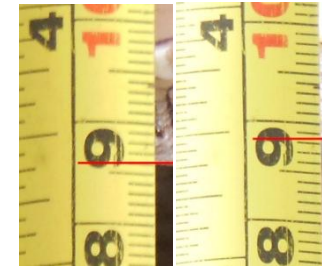
Foto 17. Medida 2. Deformación derecha: 8.6 cm e izquierda: 8.8 cm
