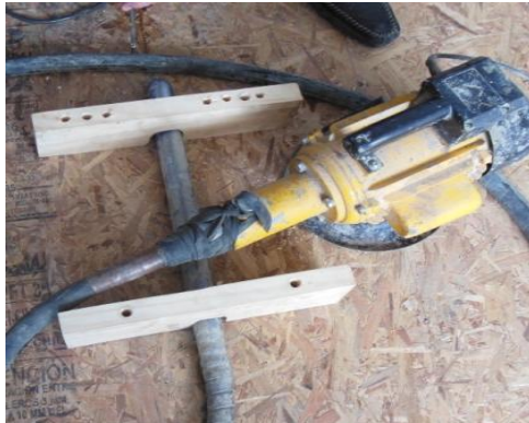
Foto 31. Piezas de madera para anclaje de vibrador
