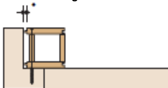
Fig. 12 Sistema Lignatur Box Element 10
