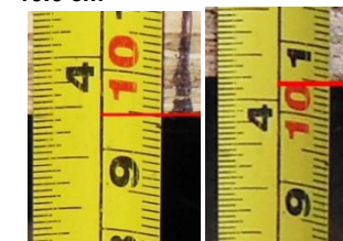
Foto 29. Medida 3 En placa con carga 9.5 cm y sin carga 10.5 cm
