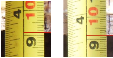
Foto 15. Medida 0. Deformación derecha: 9.1 cm e izquierda: 9.2 cm
