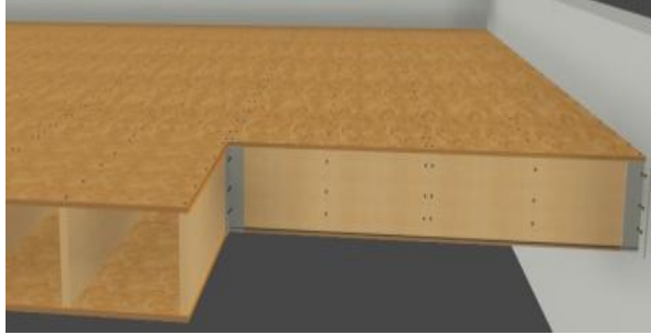
Gráfico 33. Abertura en el forjado
