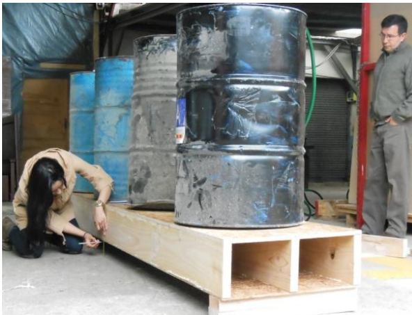
Foto 14. Toma de medidas en el centro de la luz
