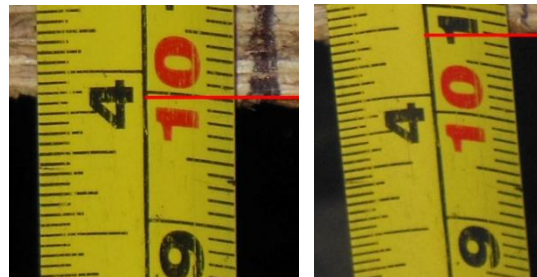
Foto 27. Medida 1 en placa con carga 10 cm y sin carga 10.8 cm
