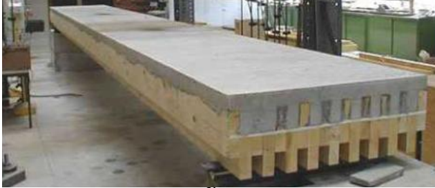
Fig. 32 Forjado, luz libre 15 m 15
