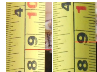
Foto 18. Medida 3. Deformación derecha: 8.4 cm e izquierda: 8.6 cm
