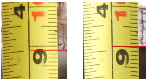
Foto 16. Medida 1. Deformación derecha: 8.9 cm e izquierda: 9.0 cm
