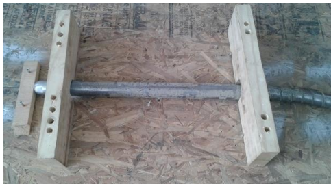
Foto 32. Para soportar la fuerza del impacto se colocó varios tornillos contra el tablero OSB
