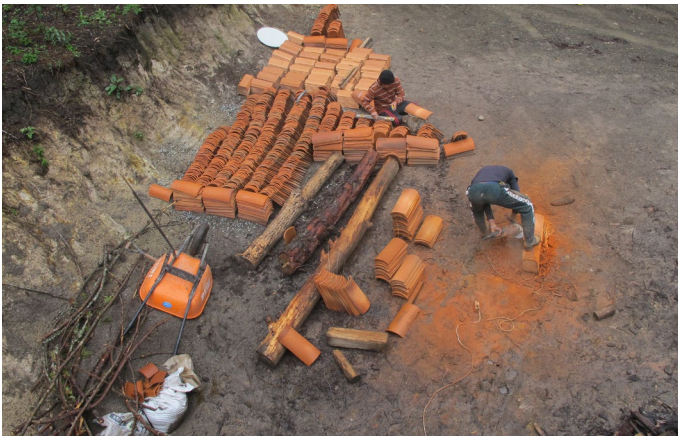
Foto_113: Las tejas cortadas para corregir sus lados.
