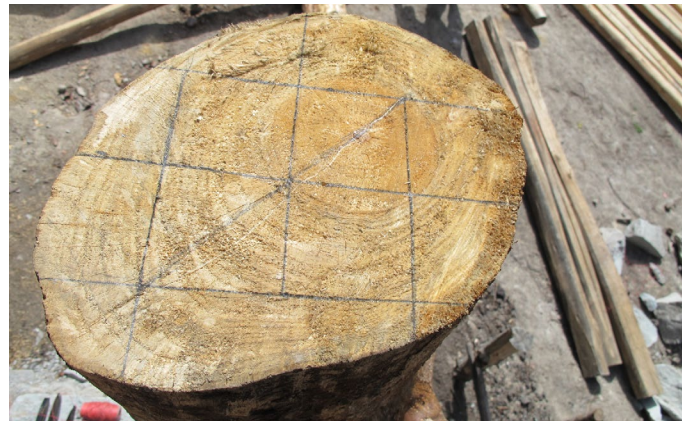
Foto_82: Primero se dibuja y luego se corta.
