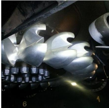
**Figura 19 Turbina Hidráulica Pelton Central Molino**
