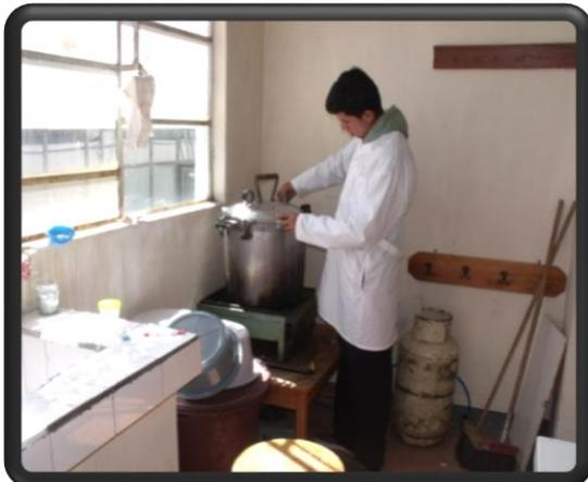
FOTO 3 esterilización en Autoclave de los tubos con BHI
