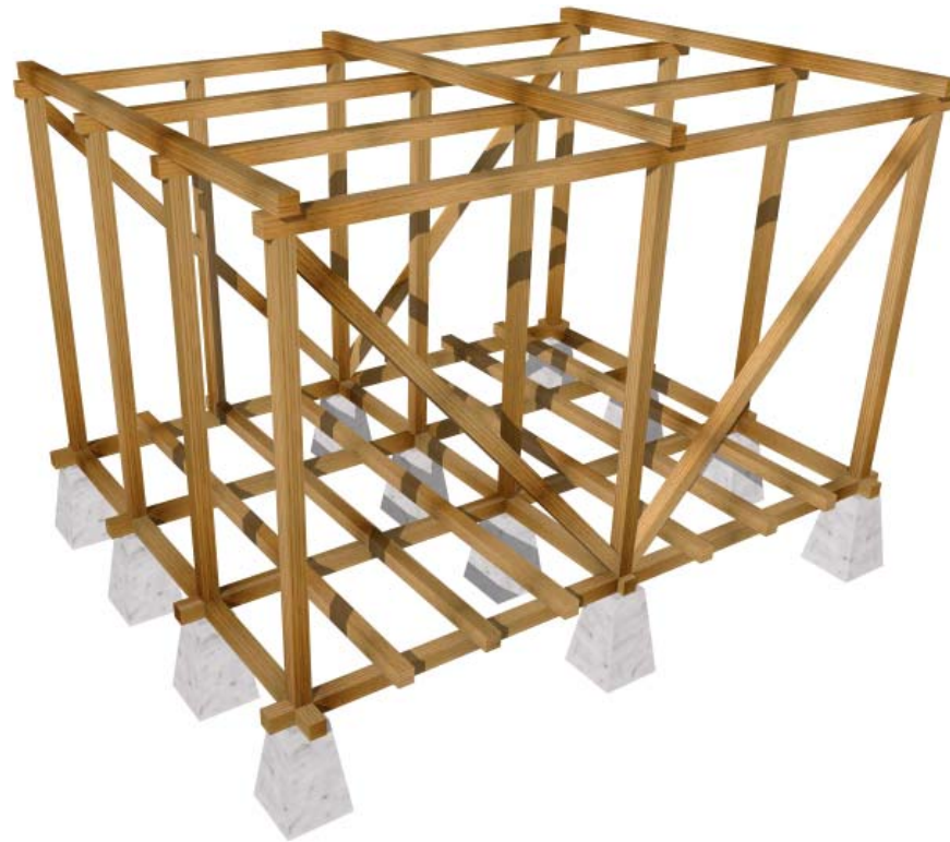
Figura 124. Estructura de madera para Bahareque.
