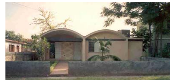
Figura 39. Primera vivienda construida con bloques machihembrados de suelo cemento en la ciudad de Matanzas, 1992. Esta fue la solución constructiva más empleada en las viviendas de "bajo consumo" a lo largo del país durante la década de los años '90s.
