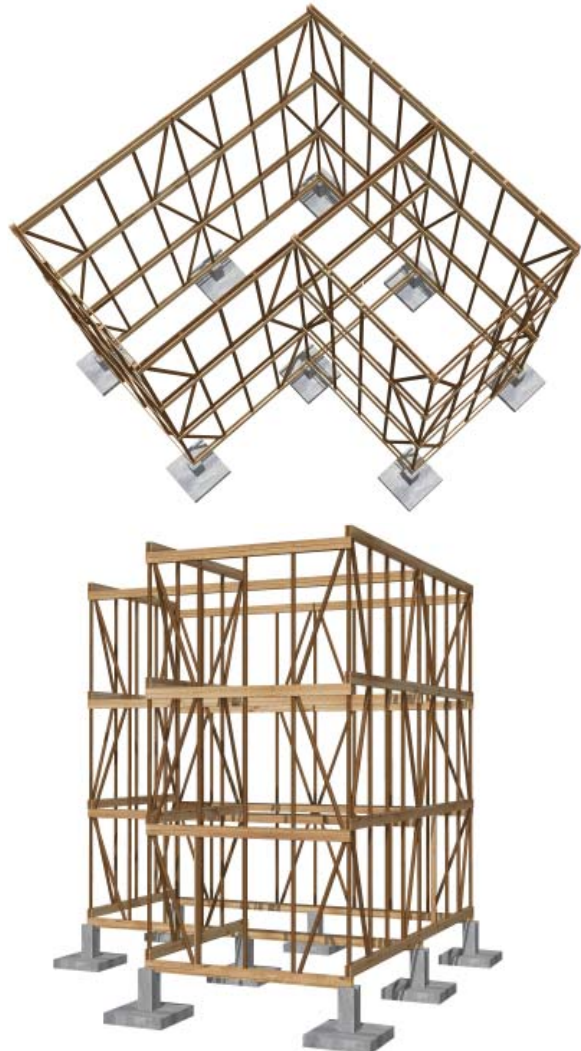
Figura 231. Primera propuesta de la estructura.
