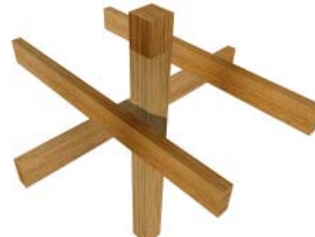
Figura 115. Viga sobre Pilar.
