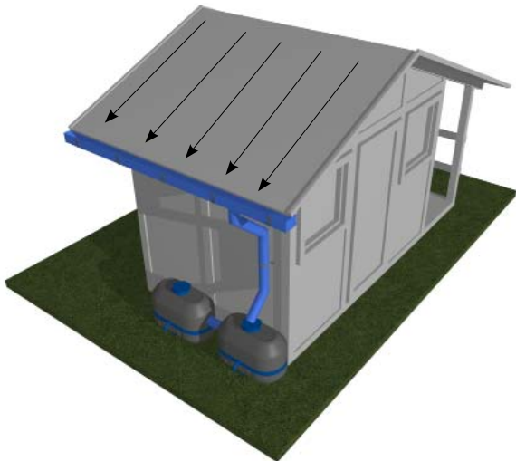
Figura 256. Sistema de recolección de Aguas pluviales.
