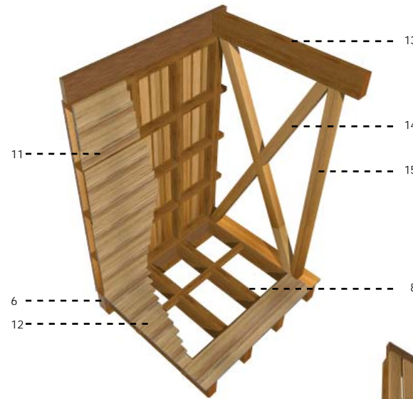
Figura 150. Detalle de volado.
