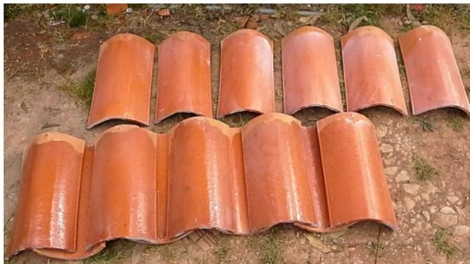
**Figura 5.21** Tejas vidriadas luego de la última quema realizada en el Horno de Manuel Riera.
