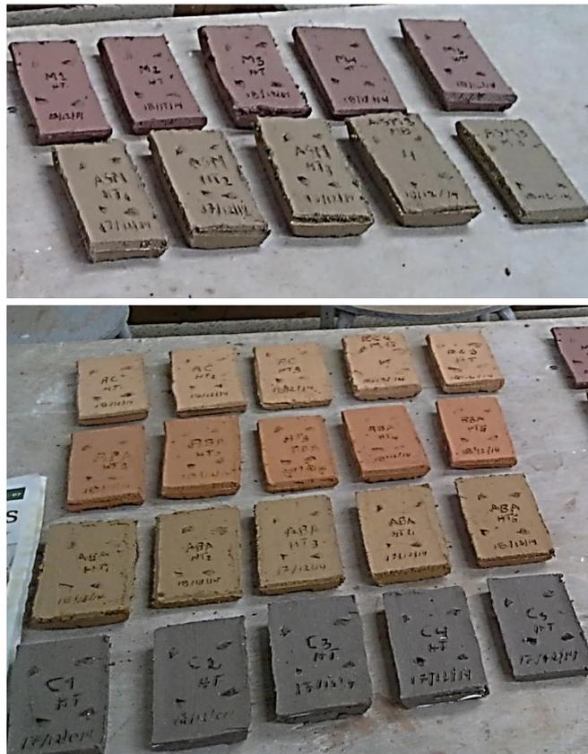
**Figura 3.1** Placas realizadas con las arcillas utilizadas por los artesanos semimecanizados, para medir contracción al secado
