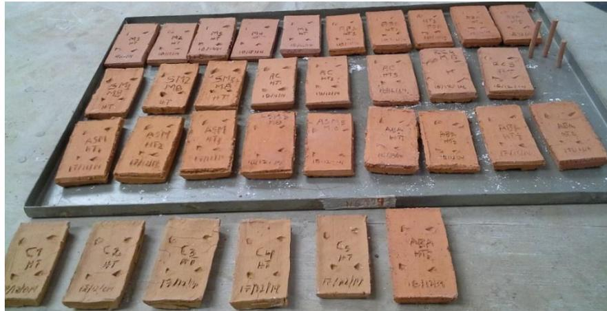
**Figura 3.2** Placas quemadas a la temperatura de 1000°C
