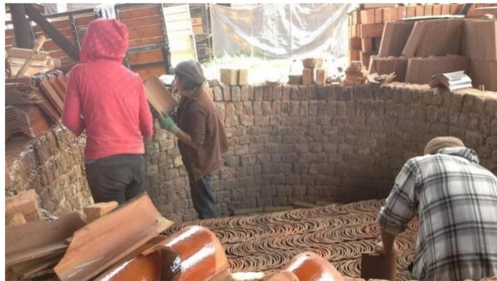
**Figura 2.16** Colocación de las tejas en el interior del Horno artesanal de sección circular.
