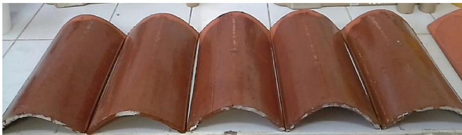
**Figura 5.23** Tejas vidriadas con la frita EFA 80 quemadas en el horno eléctrico
