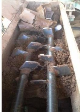
Figura 2.11 Mezclador de tipo cubeta continuo de la extrusora.
