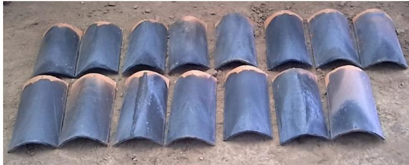
**Figura 5.18** Tejas de color negro después de la segunda prueba en la quema con el horno de tiro invertido
