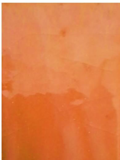
**Figura 5.6** Experimento 3+++ con Frita A5 8200 mejor resultado obtenido al disminuir el craquelado con la frita Chivit.
