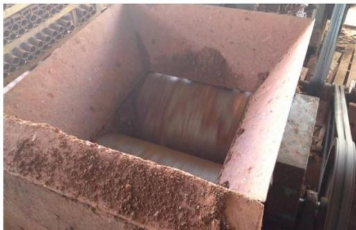
**Figura 2.9** Molino de rodillos
