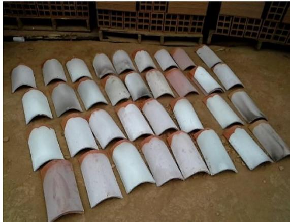
**Figura 5.13** Tejas con la frita no fundida luego de la primera prueba ubicadas en la cúpula y zona media del horno.
