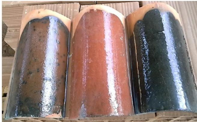
**Figura 5.14** Tejas con la frita fundida luego de la primera prueba ubicadas cerca de la tercera boca de combustión del horno.
