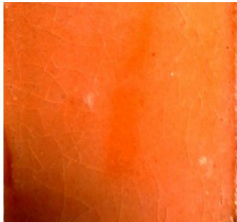
**Figura 5.4** Craquelado con la frita A5 8200 con los experimentos modificados.
