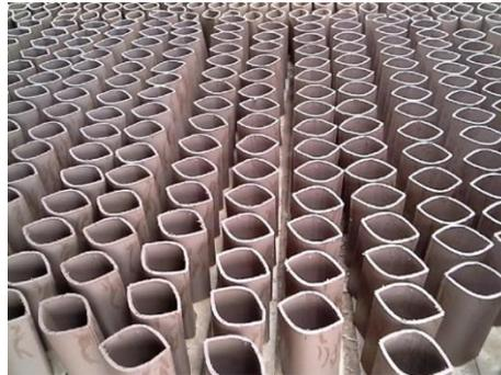
**Figura 5.7** Tejas elaboradas en los talleres de los artesanos semimecanizados.
