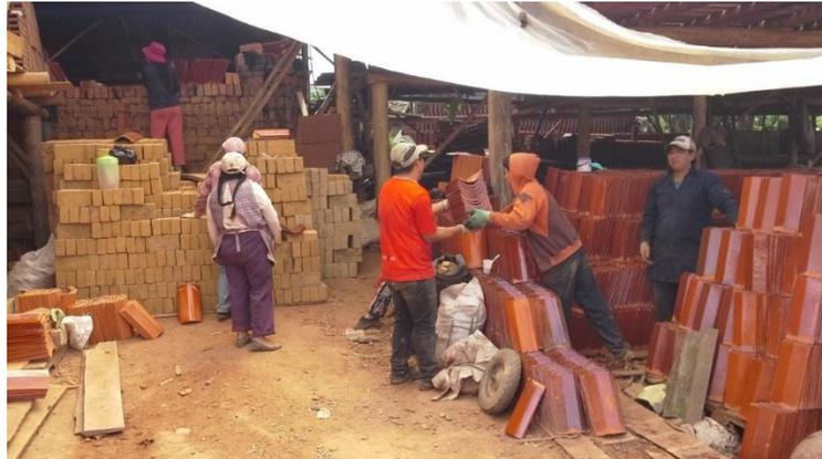
**Figura 2.18** Descarga y almacenamiento de las tejas vidriadas del horno artesanal.
