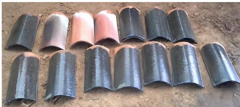
**Figura 5.19** Tejas de color verde oscuro después de la segunda prueba en la quema con el horno de tiro invertido.
