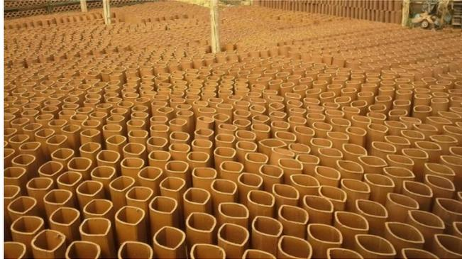
**Figura 2.14** Secado de tejas.
