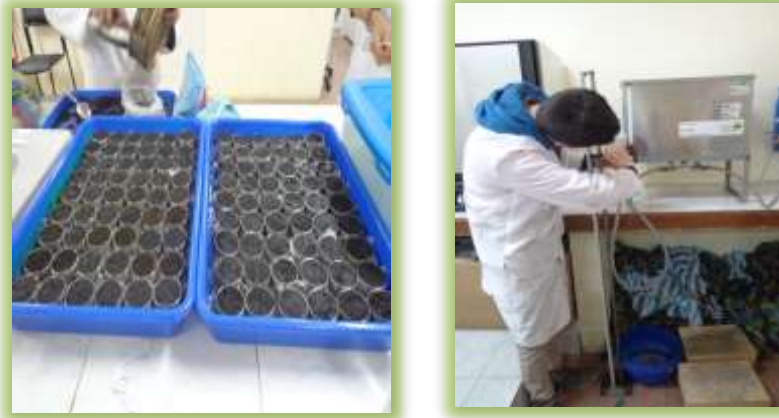
Figura 12. Saturación de anillos y Caja de arena ( pF=0.5 y 1.5 ) Fuente: Pacheco y Tapia, 2015
