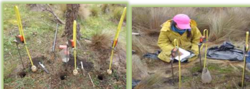
Figura 16. Pruebas de pozo invertido Fuente: Pacheco y Tapia, 2015
