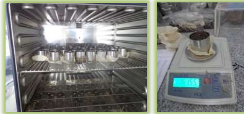
Figura 11. Secado y pesaje de las muestras
