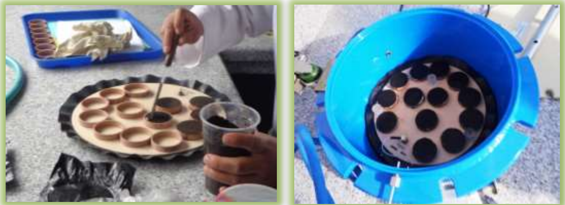
Figura 14. Placas con pasta saturada Fuente: Pacheco y Tapia, 2015
