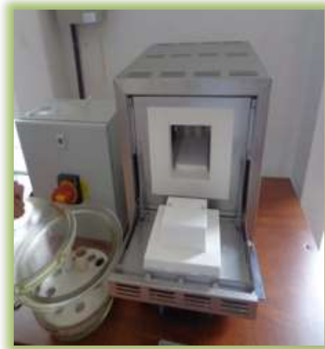
Figura 18. Ignición o calcinación para materia orgánica Fuente: Pacheco y Tapia, 2015
