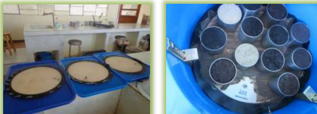
Figura 13. Contenido de humedad (punto pF=2.52 ) Fuente: Pacheco y Tapia, 2015
