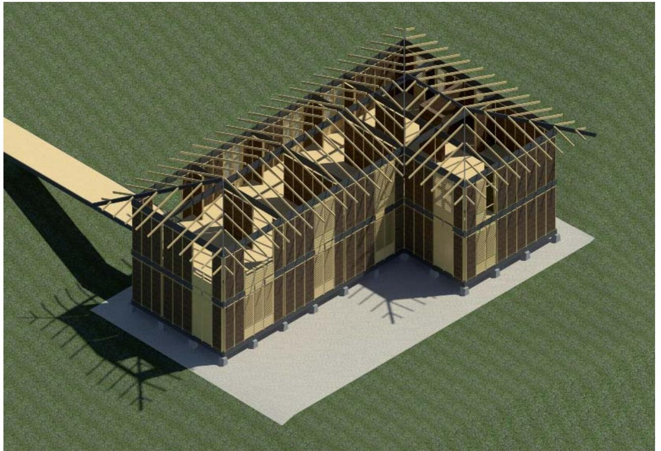
10. Colocando tirantes prefabricados
