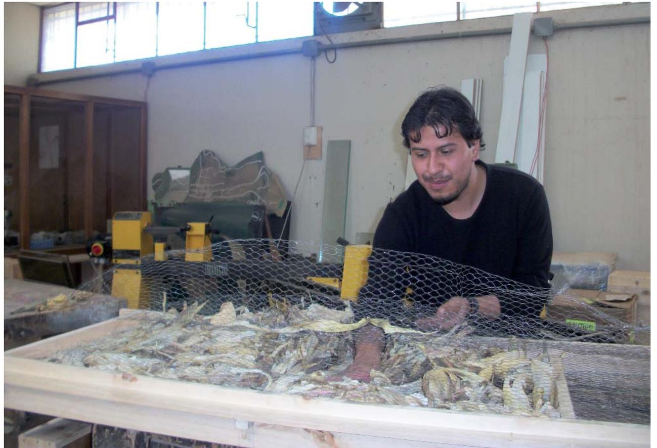
7. Colocando aislante de pucón compactado y sellado con malla de gallinero (laboratorio de Arquitectura)
