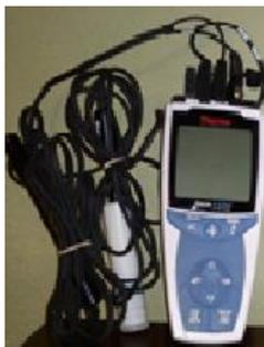
Figura 6. pHmetro portátil de marca Thermo Orion 4-Star.
