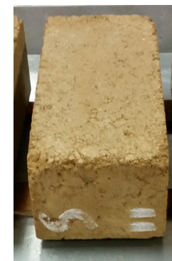
fig. 24 - Ensayo Humectación - muestra cloruro de sodio (6%) + Cal (2%)
