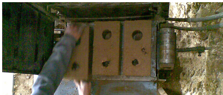
fig. 25 Maquina para la Elaboración de BTC
