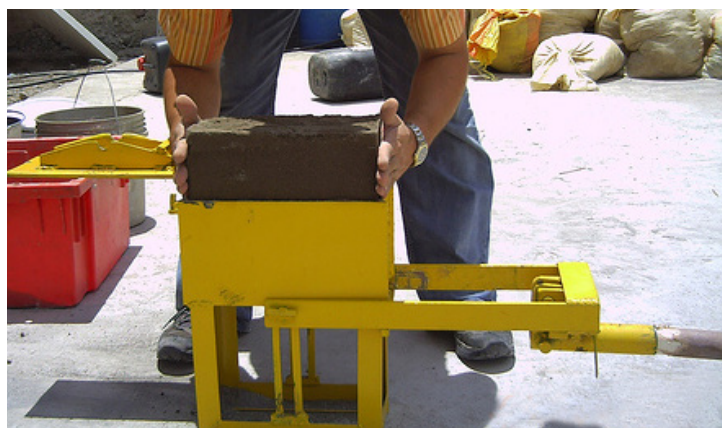
fig. 37 - Prensa Manual para adobes, CINVA RAM
