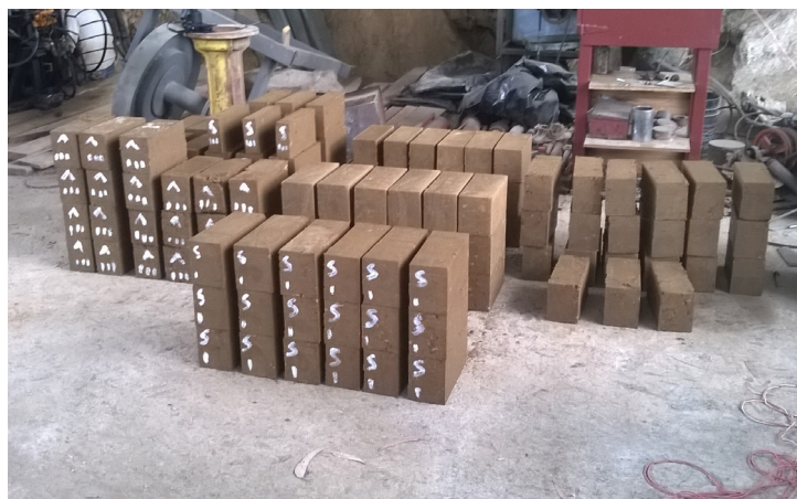
fig. 16 - Secado de Adobes Prensados
