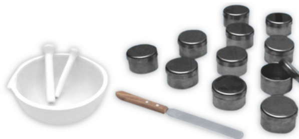
fig. 25 - Ensayo de límite Plástico, instrumentos.
