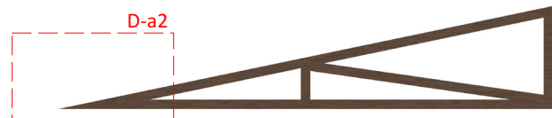
Fig. 50 CERCHA TIPO DIENTEL DE SIERRA
