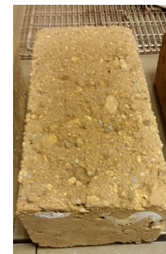
fig. 23 - Ensayo Humectación - muestra cloruro de sodio (3%) + Cal (2%)
