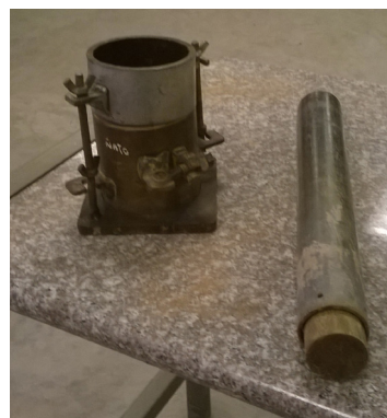
fig. 29 - Cilindro Proctor - Pisón.
