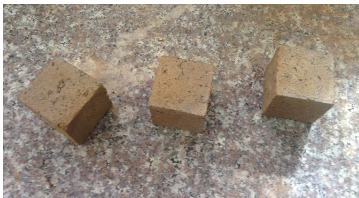
fig. 27 - Ensayo Contracción lineal - Baños.
