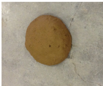
fig. 16 - Ensayo de caída de bola, Baños.
