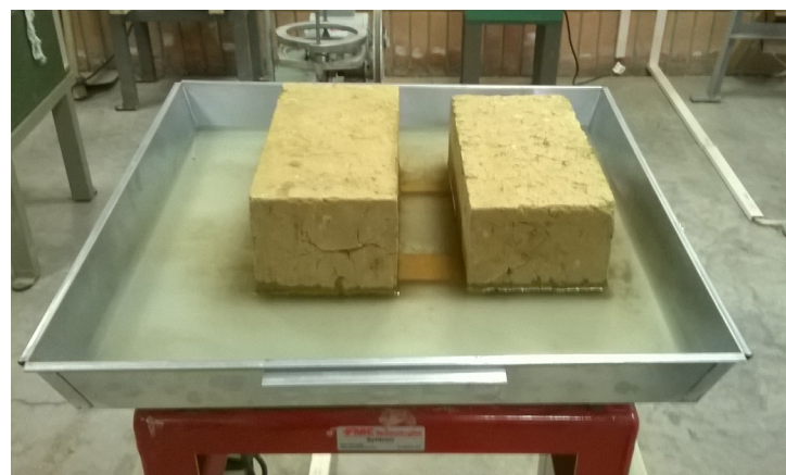
fig. 19 - Ensayo de absorción por capilaridad
