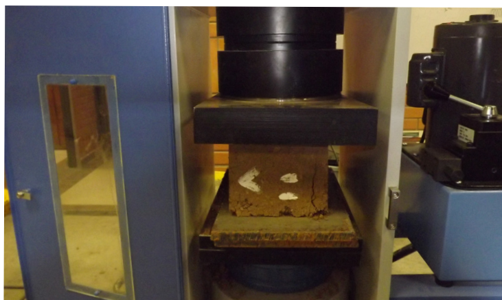
fig. 18 - Equipo para ensayos de resistencia a la compresión, Proceso
