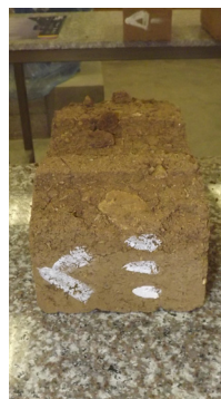
fig. 22 - Ensayo de Humectación - muestra Cáscara de arroz (10%)
