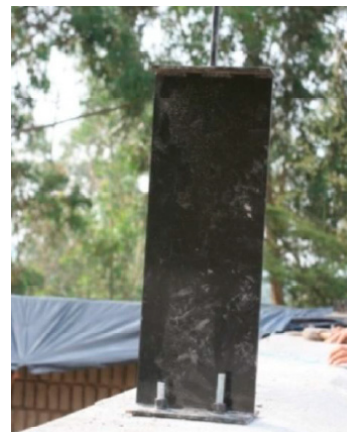
fig. 42 - Placa metálica para formar bloques
