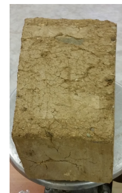
fig. 25 - Ensayo Humectación - muestra cloruro de sodio (10%) + Cal (2%)
