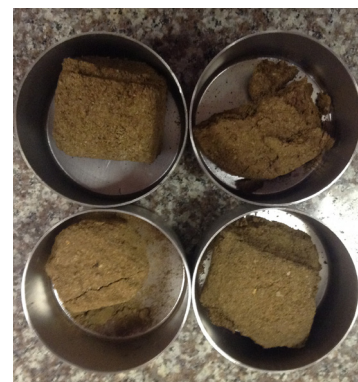
fig. 30 - Muestra ensayo compactación
