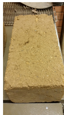
fig. 26 - Ensayo Humectación - muestra sin estabilizante
