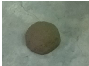
fig. 17 - Ensayo de caída de bola, Giron.
