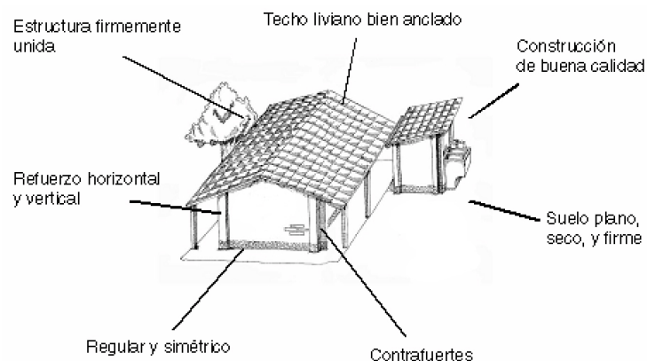
fig. 66 - Construcción de adobe sismoresistente.
