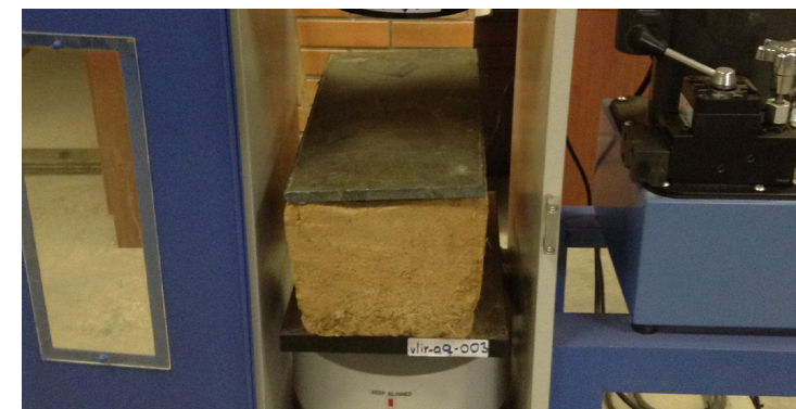
fig .21 - Ensayo de Compresión Simple de Adobes
