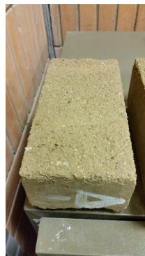
fig. 20 - Ensayo de Humectación - muestra Cáscara de arroz (3%)
