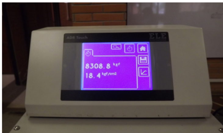
fig. 17 - Equipo para ensayos de resistencia a la compresión, Resultados
