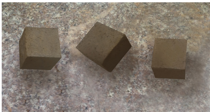
fig. 28 - Ensayo retracción lineal - Baños.
