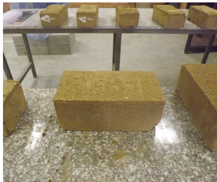
Fig. 2 - Bloque de Adobe Prensado Estabilizado con Cascara de arroz.
