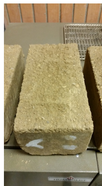
fig. 21 - Ensayo de Humectación - muestra Cáscara de arroz (6%)
