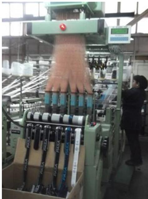
Figura 1-11 Máquina tejedora de cintas elásticas
