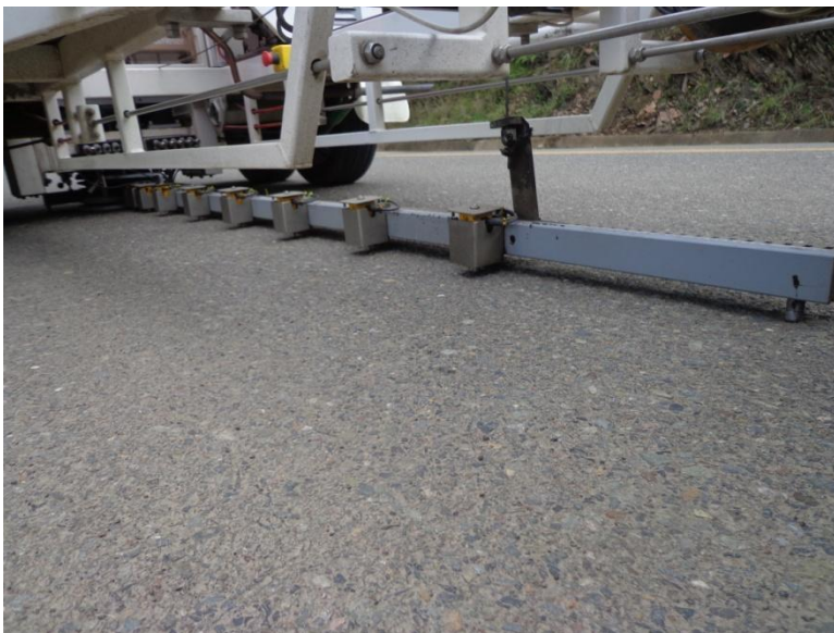
Figura 2. Deflectómetro de Impacto - PRIMAX FWD del Ministerio de Transporte y Obras Públicas.
