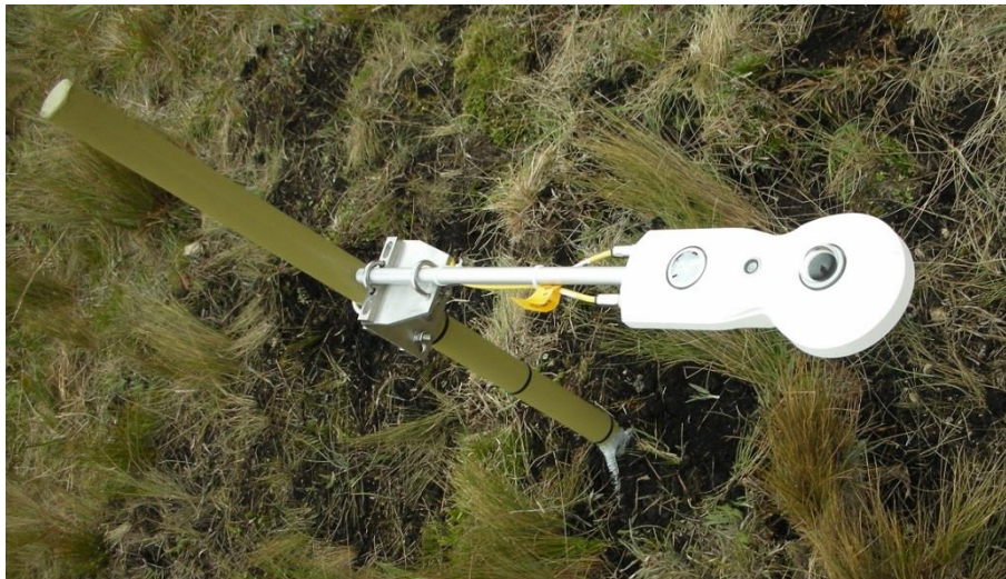
Figura 3 Radiómetro neto CNR4 in situ. Fuente: (iDRHiCA)
