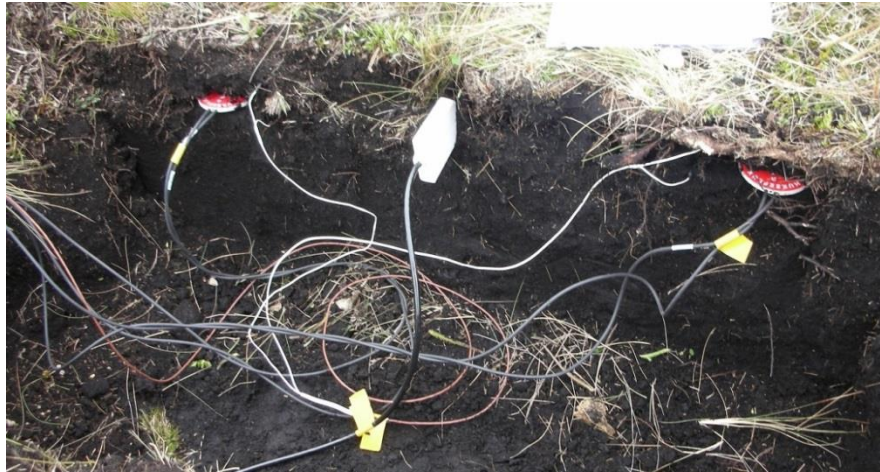
Figura 4 Disposición in situ y teórica de platos de flujo y termopilas. Fuente: (Manual HFP01SC-iDRHiCA)
