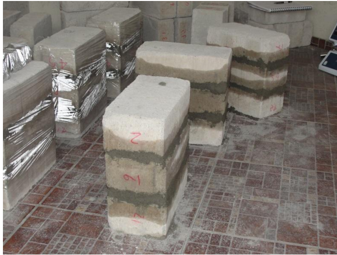
Figura 33. Fabricación de muretes, muretes curados y sin curar. Fuente: Autor
