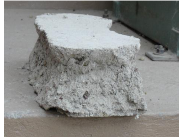
Figura 47. Típica falla a compresión del BTC.
