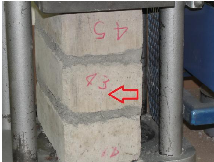
Figura 48. Inicio de fisuración en murete ensayado. Fuente: Autor.
