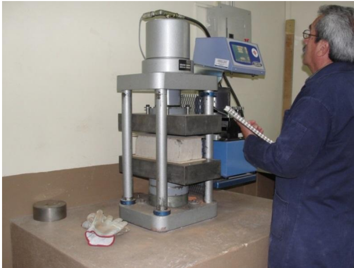
Figura 27. Pruebas de compresión axila de los BTC. Fuente: Autor
