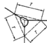
Figura 2 – Desconchado en una esquina
