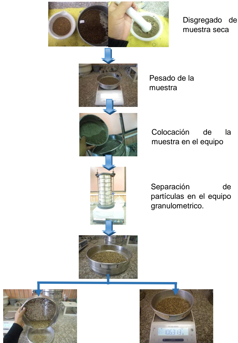
Figura 12. Esquema del proceso del ensayo de granulometría.
