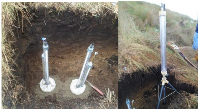
Lado izquierdo: prueba infiltrómetro de tensión; lado derecho: prueba permeámetro de Guelph. Fotografiada por: Jéssica Guncay A., 2014.
