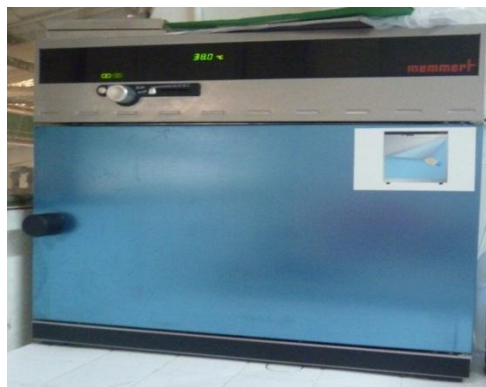
Figura 9. Estufa de incubación Memmert con un rango de temperatura de trabajo: +30° a 70°C.
