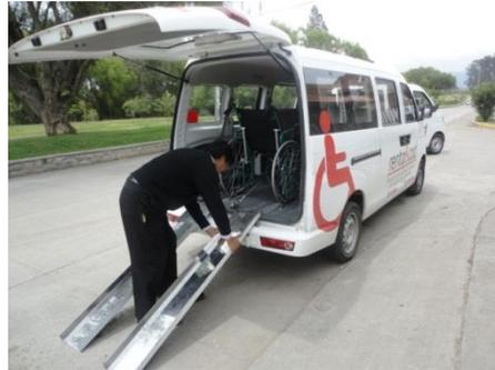
**Foto 150:** Colocación de rampas en el vehículo de Renta Cad
