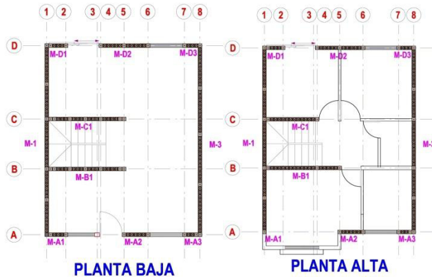
Figura 1.23 Disposición de muros
