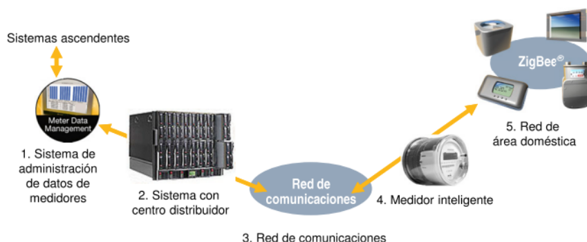
Gráfico 5.5. Ejemplo de sistema AMI (Tomado de catálogo de la firma AITRON)
