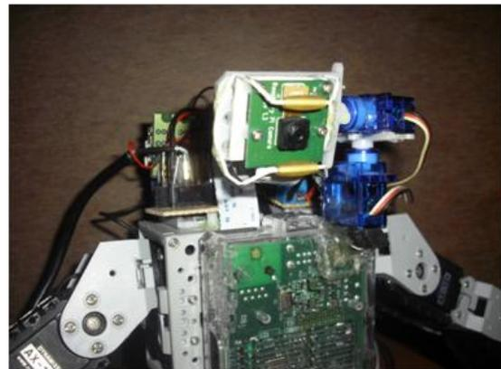
**Figura 2.** Vista delantera del robot con la cámara y servomotores instalados.
