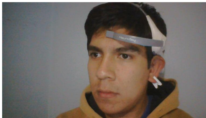
Figura 1. Sujeto de prueba utilizando el dispositivo MindWave (El dispositivo se utiliza según se muestra en la figura).
