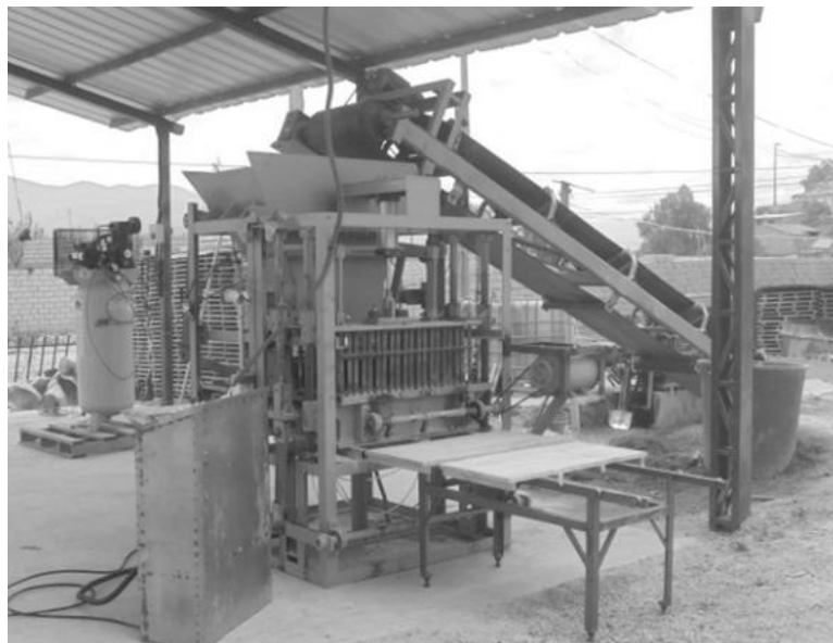
Figura 12. Máquina semiautomática para fabricar bloques construida.
