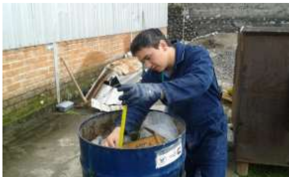
Figura 6. Medición de la altura que han descendido los residuos sólidos
