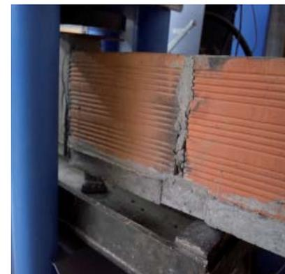
148: Muestra 3, Alma, Ensayo de Flexión.
