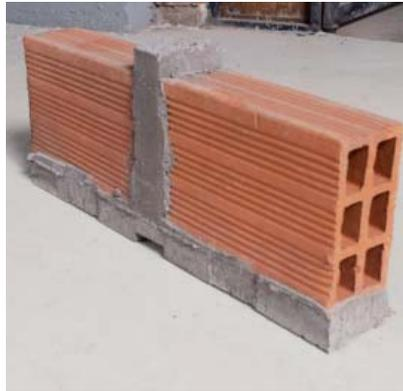
141: Muestra 1, Alma, Ensayo de Compresión.
