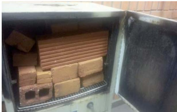
30: Ladrillo. Ensayos de Humedad.
