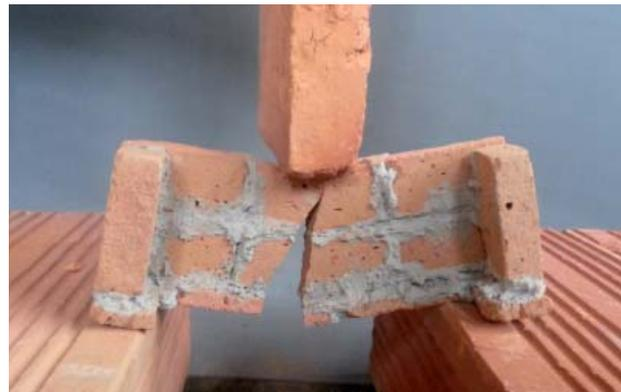
98: Módulos a Escala, Falla por Carga.
