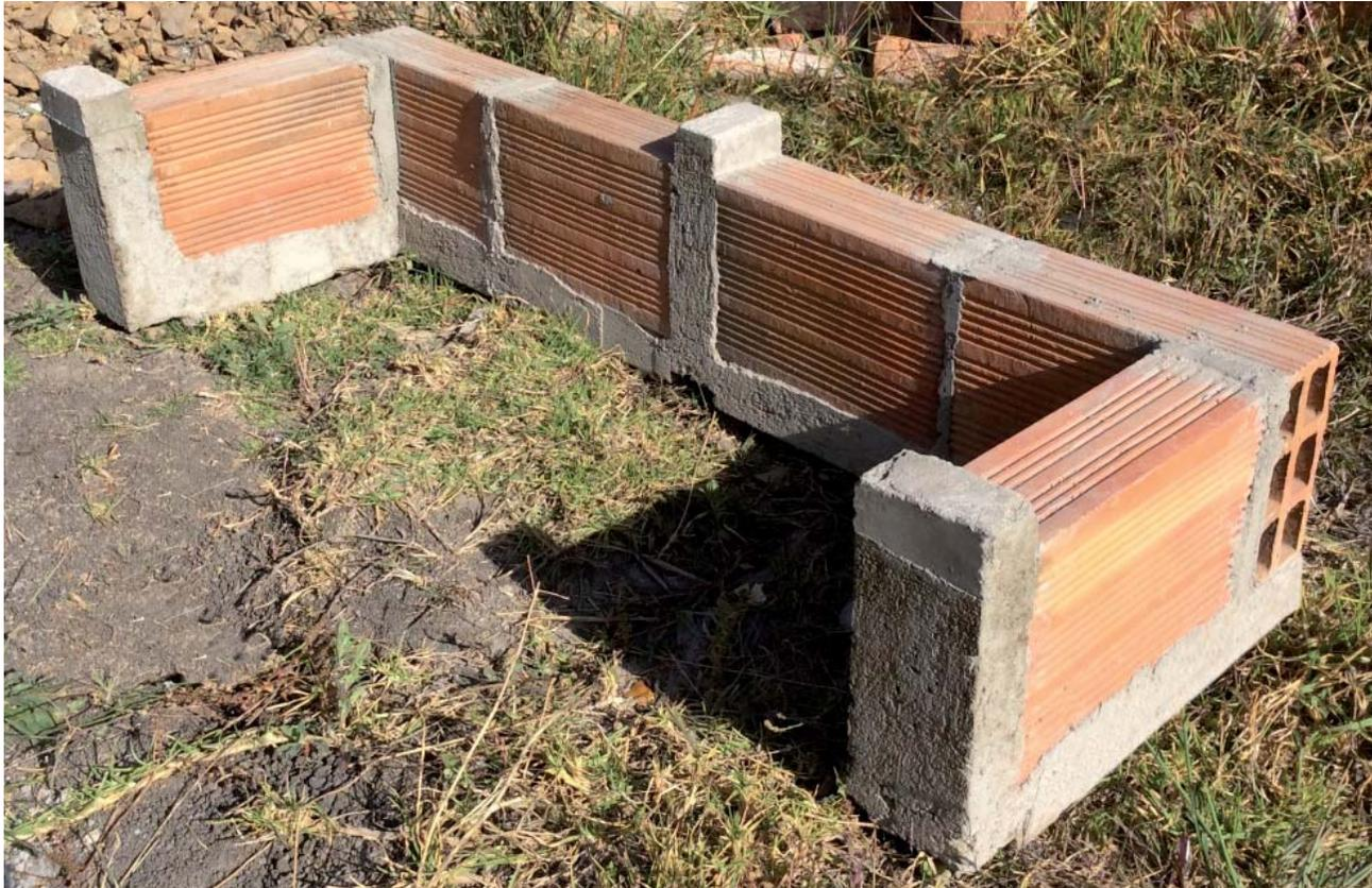
Éste tipo de módulo se basa en un proceso experimental donde se aplica la Normativa NEC-10, Parte 5, Capítulo 3.1.6.2, “Determinación Experimental de  $f'm$ ” que trata de la resistencia a la compresión de la mampostería.
