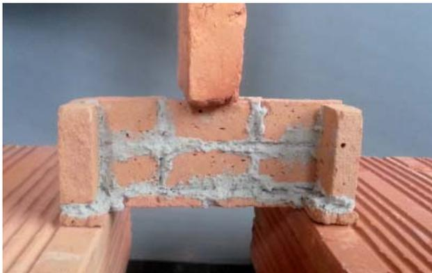
97: Módulos a Escala, Pueba de Carga.
