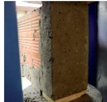
145: Muestra 2, Ala, Ensayo de Compresión.
