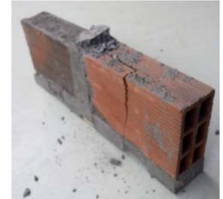
143: Muestra 1, Alma, Ensayo de Compresión.
