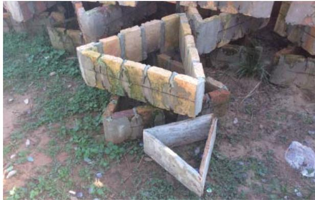
435: U.N.A. Módulos Cerámicos Triangulares, Encofrado de Madera.
