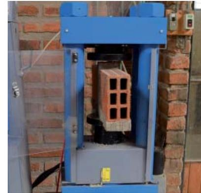
142: Muestra 1, Alma, Ensayo de Compresión.
