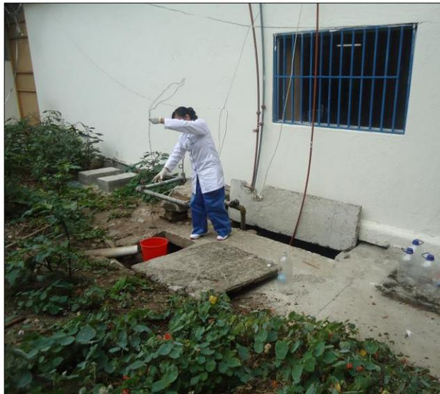
**Figura 10** Toma de muestra de aguas residuales.
