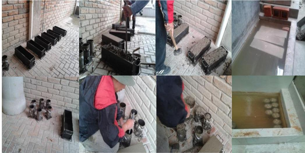
Ilustración 18 Elaboración de viguetas y cilindros para ensayos de compresión y flexión
