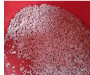
Ilustración 9 Material retenido en tamiz 4,75mm
