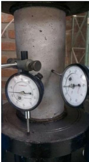
Ilustración 24 Registro en laboratorio de deformación laterales y longitudinal
