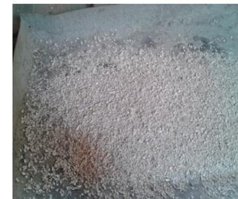
Ilustración 11 Material pasante el tamiz 4,75mm
