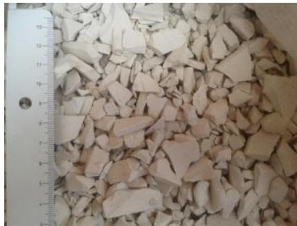
Ilustración 10 Material triturado sin finos sin partículas de diámetro menor a 4.75mm
