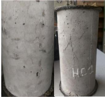
Ilustración 21 Tipo de fractura de cilindro
