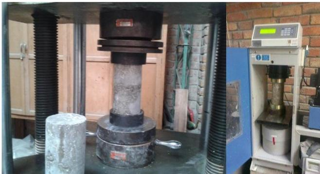
Ilustración 20 Ensayo a compresión en cilindro de 10 x 20 cm
