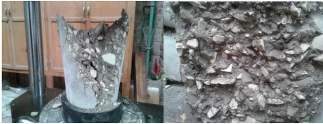
Ilustración 22 Acercamiento de muestra fallada por compresión
