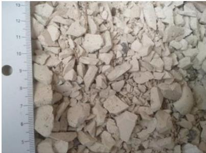
Ilustración 8 Material triturado completo con partículas de diámetro menor a 4.75mm
