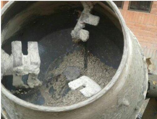
Ilustración 14 Mezclado inicial de agregado cerámico
