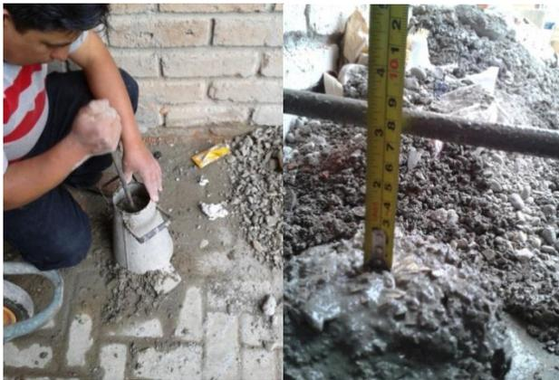
Ilustración 19 Asentamiento medido mezcla cerámica nueva completa
