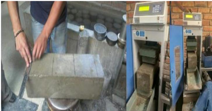
Ilustración 23 Ensayo a flexión en vigueta de 15 X 15 X 50 cm.
