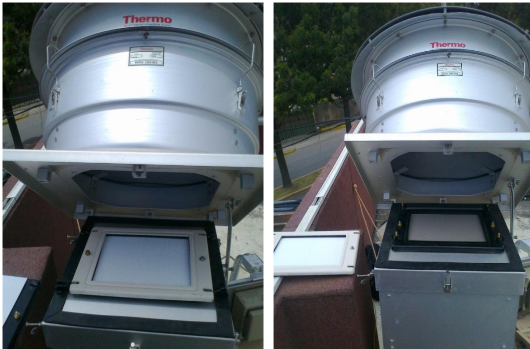
Figura 3.2.4 Portafiltros con filtros antes y después de un monitoreo
