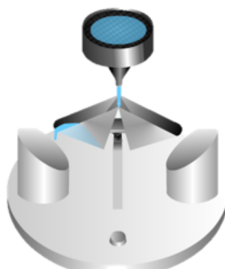
Figura 3.4: Balancines que se llenan con el líquido [6]
